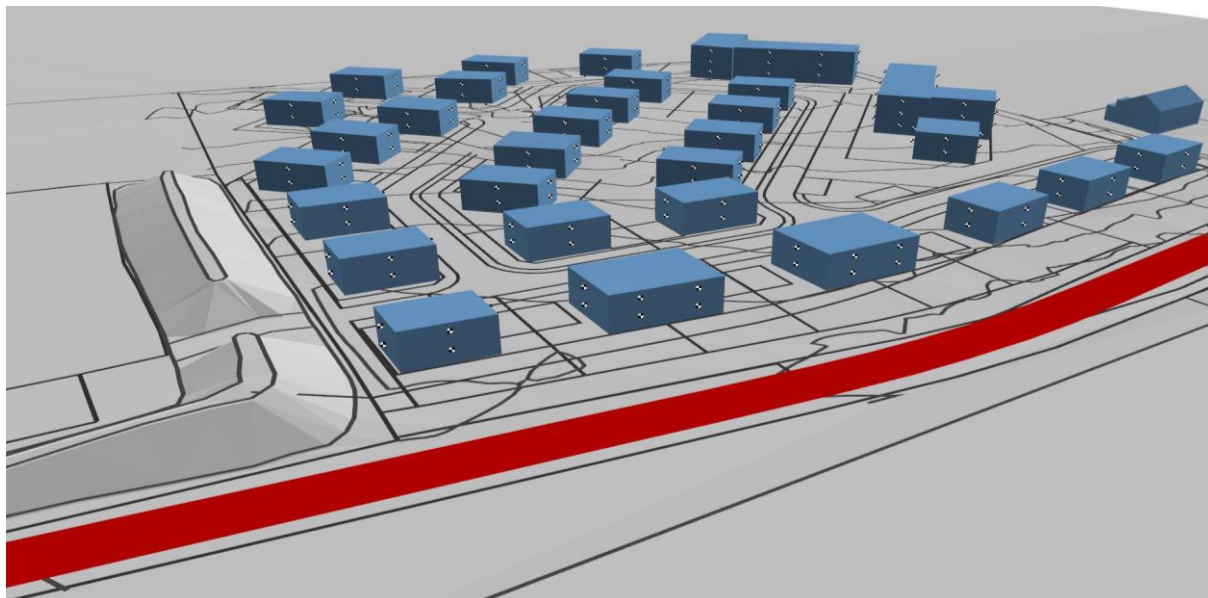
3D-Darstellung im Schallschutzprogramm: Geplante Gebäude (Haus 1 bis Haus 32) und generierte Immissionspunkte je Gebäude / Blickrichtung Norden; links im Bild der durchbrochene Erdwall
