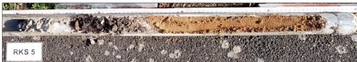
Bild 12: erster Bohrmeter der RKS 5 mit Straßenkonstruktionsschichten Mühlweg
